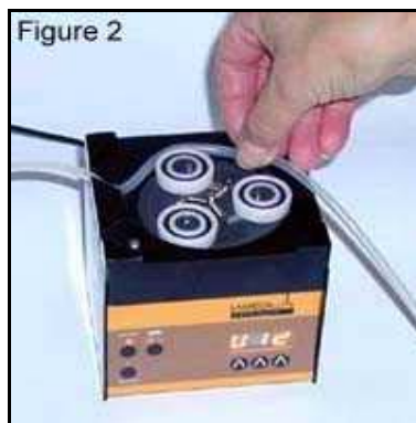
Fig. 2: Inserción de la manguera / tubería
