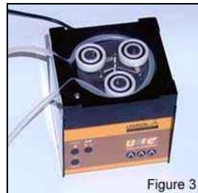
Fig. 3: Manguera / tubería en el cabezal
