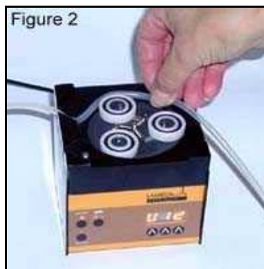
Fig. 2: Inserción de la manguera / tubería
