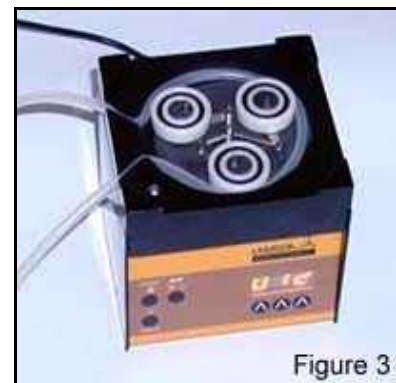
Fig. 3: Manguera / tubería en el cabezal
