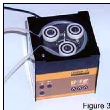
Fig. 3: Tubo nella testa della pompa
