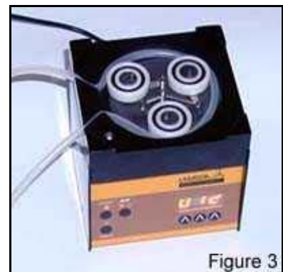
Fig. 3: Tubo nella testa della pompa
