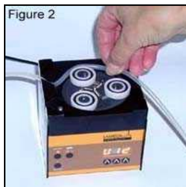
Fig. 2: Inserimento del tubo
