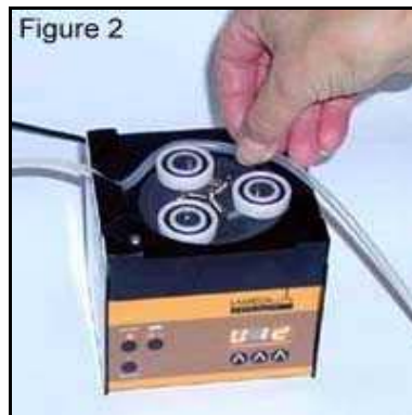
Fig. 2: Einführen des Schlauches
